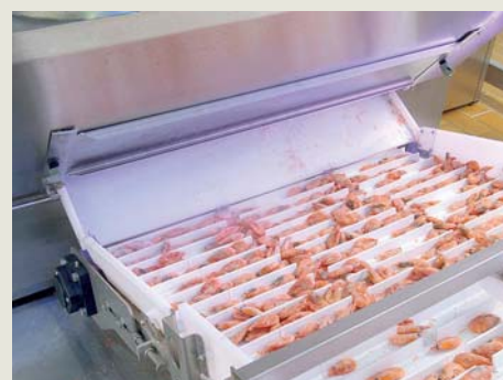
Udløbshøjden er 435 mm, hvilket giver god plads til rengøring af gulv
